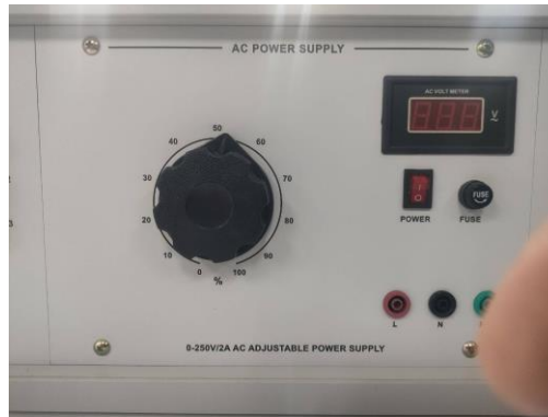
ภาพที่ 3-8 แหล่งจ่ายไฟฟ้ากระแสสลับ (AC Power Supply)
