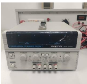
ภาพที่ 3-7 แหล่งจ่ายไฟฟ้ากระแสตรง (DC Power Supply)
